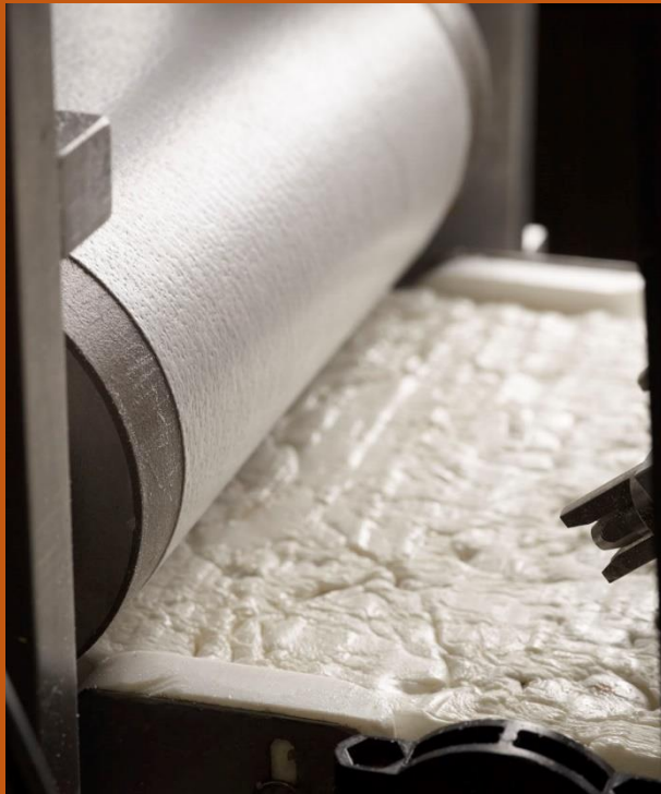
Foto 1: extrusie van de warme nougat op de transportband
