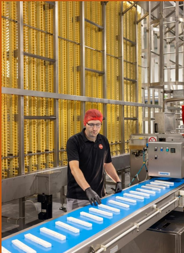
Foto 2: automatisch snijden van de nougat in repen
